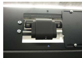
Rys. 8.c – Zdalny czujnik temperatury i wilgotności
